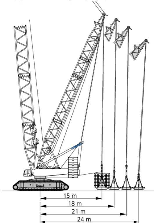
**Variable Superlift attachment · Variable Superlifteinrichtung · Superlift variable ·
