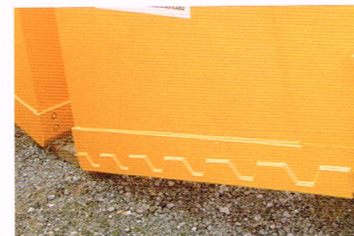
Zusätzliche Stahldichtleisten für den Umschlag von feinkörnigem Schüttgut Additional steel sealing lips for handling of fine-grain bulk material
