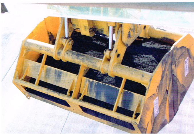
Schalen mit reduziertem Volumen (geöffneten Überlaufklappen) Scoops with reduced volume (opened spill plates)
