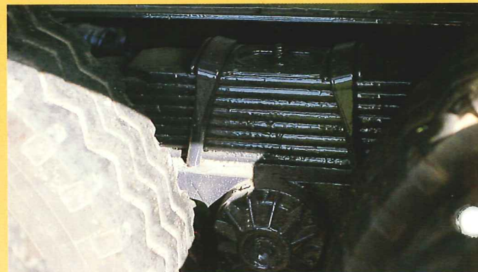
SUSPENSION - DIRECTION à grand angle de braquage : 45° avec suspension hydraulique indépendante à l'avant réglable et blocable - Tandem à suspension à lames formant balancier à l'arrière.
