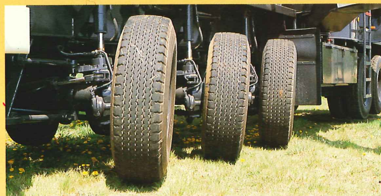
SUSPENSION - DIRECTION à grand angle de braquage : 45° avec suspension hydraulique indépendante à l'avant réglable et blocable - Tandem à suspension à lames formant balancier à l'arrière.
