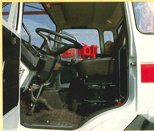
CABINE PORTEUR frontale 3 places - Siège conducteur réglable à 4 positions - Tableau de bord complet.
